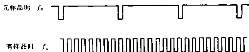
图 5-6 加在 ECD 池上的极化电压脉冲频率调制示意图
