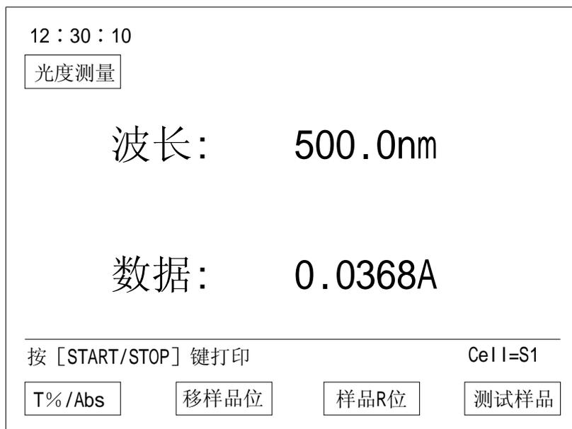
每个未知样品测量完成后，可以按[START/STOP]键对所测得数据进行打印输出。
