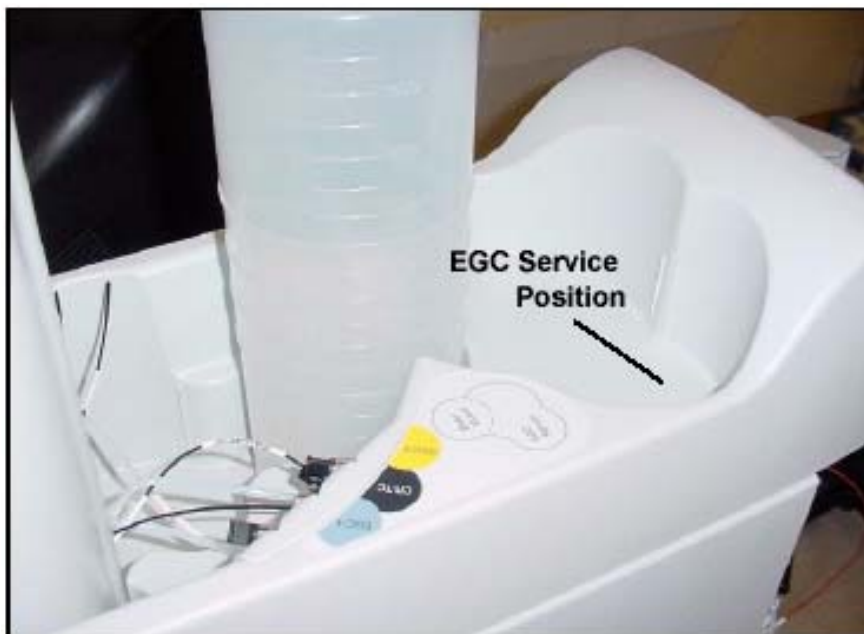
图 5-26. 淋洗液储罐的安放位置
