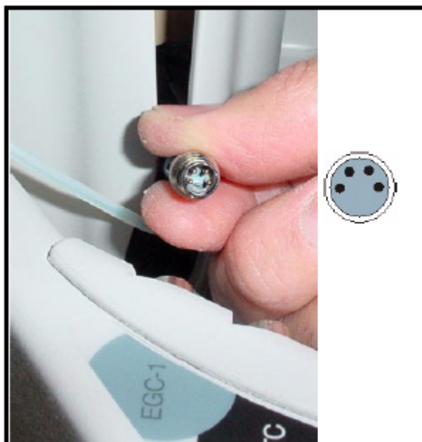
图 5-33. 连接淋洗液储罐的电缆
