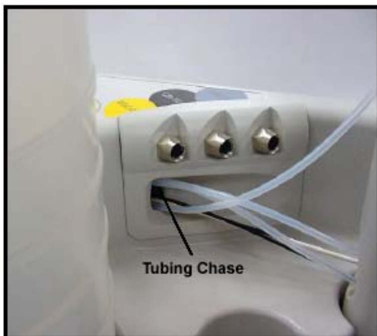
图 5-39. ICS-2100 顶部管路和接口的特写
