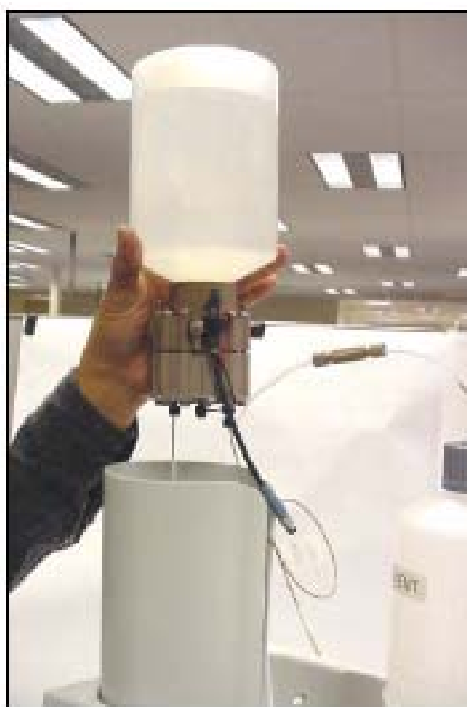
图 5-32. 安放淋洗液储罐
