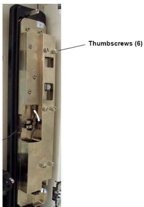
图 5-17. 拆卸柱加热器盖板
