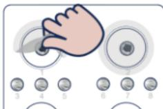
图 7-10：试剂槽混匀撕掉封口膜
