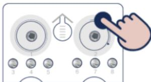
图 7-17: FCL SE50/FCL SE400 贴紧封口膜
