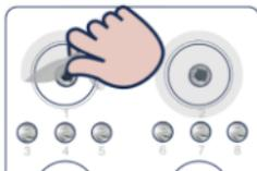
图 7-6: FCL SE50/FCL SE100 /FCS SE100 试剂槽混匀撕掉封口膜
