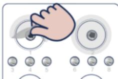
图 7-14：试剂槽混匀撕掉封口膜
